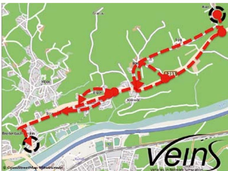
Im Simulationsmodell werden Autos auf der Fahrt von Ried nach Dorf bei einem fiktiven Verkehrsunfall auf der Landesstraße automatisch auf eine der verfügbaren Ausweichrouten geleitet. Die Unfallwarnung wird dabei zwischen den einzelnen Autos mittels Funkkommunikation innerhalb weniger Sekunden ausgetauscht.
